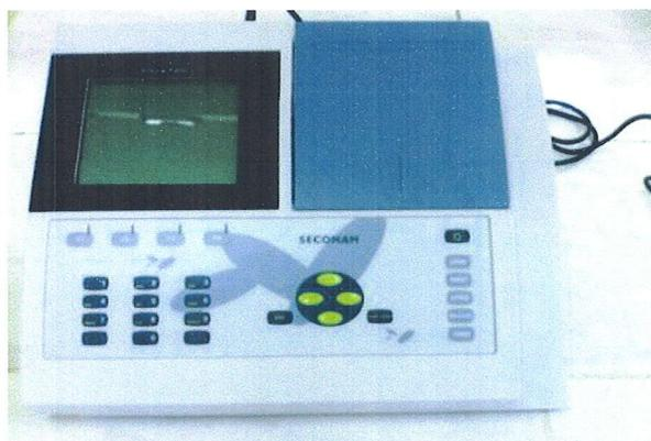
*Figure 28. Appareil spectrophotomètre UV-Visible SECOMAM*
