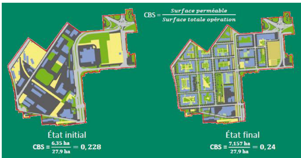
Figure 12 : Le coefficient biotope par surface de la ZAC Vigny-Musset à Grenoble. Source : bilan du plan local d'urbanisme de 2005 à partir du service prospective urbaine
