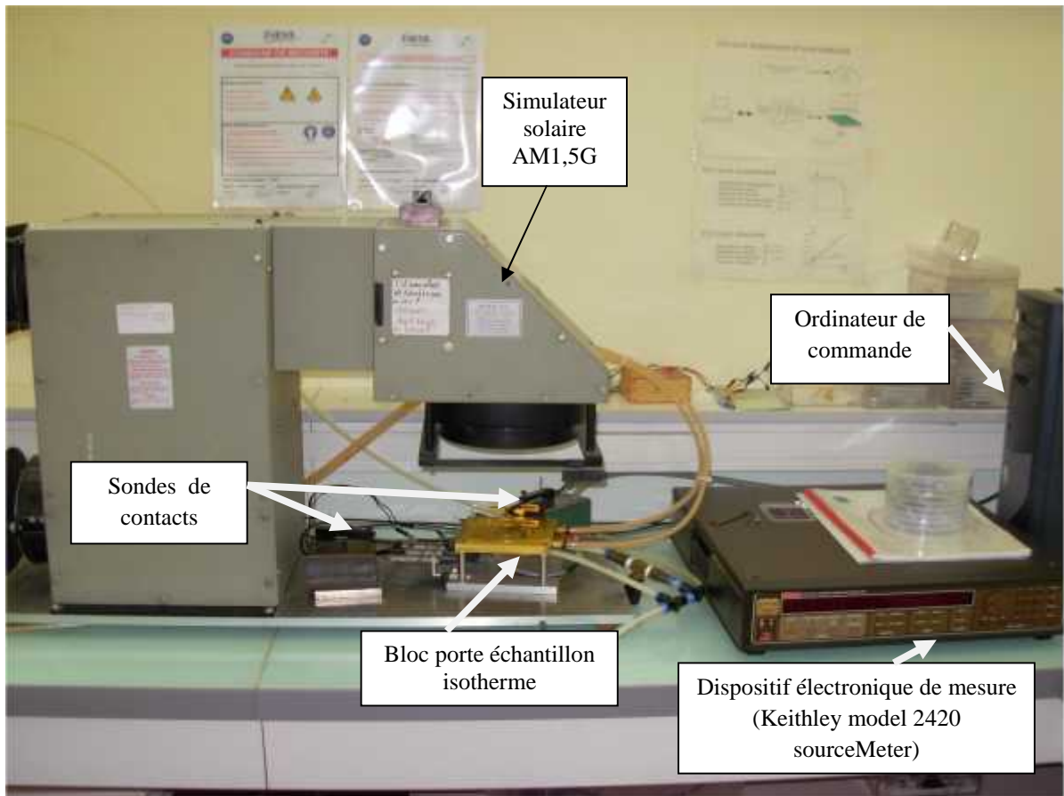
Figure IV.14 : Photo du dispositif de mesure de la caractéristique I - V sous illumination.
