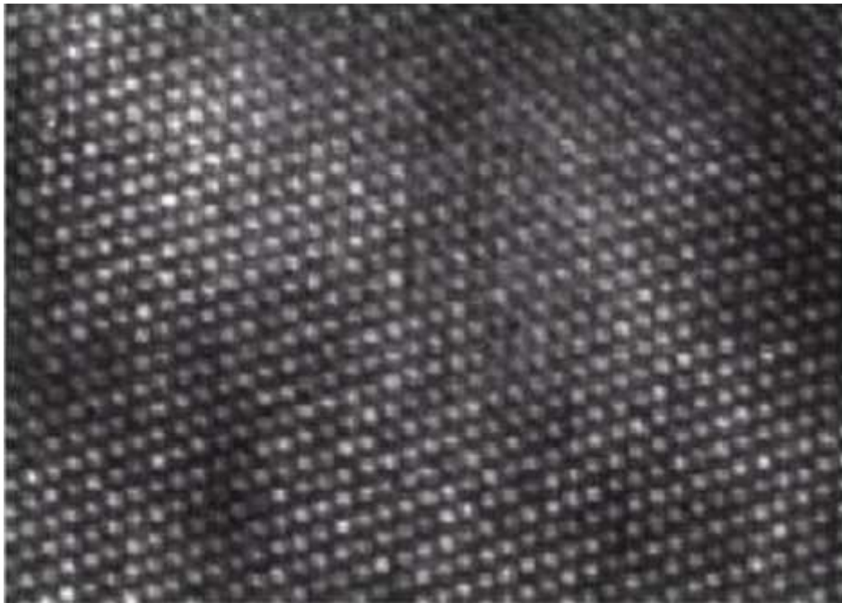
Figure I.1 : Microphotographie du réseau cristallin du silicium prise par MET [1].
