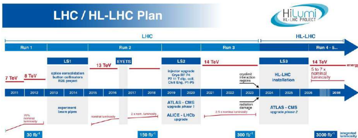
Figure 1.10: Chronologie du programme de référence de LHC et de ses phases d'amélioration montrant l'énergie des collisions (lignes supérieures en rouge) et la luminosité instantanée (lignes inférieures en rouge). Le deuxième long arrêt (LS2) en 2019- 2020 verra la consolidation de l'accélérateur et le projet d'amélioration du système d'injecteurs du LHC. Après le troisième long arrêt (LS3) en 2024-2026, la machine sera dans sa configuration finale HL-LHC [17].
