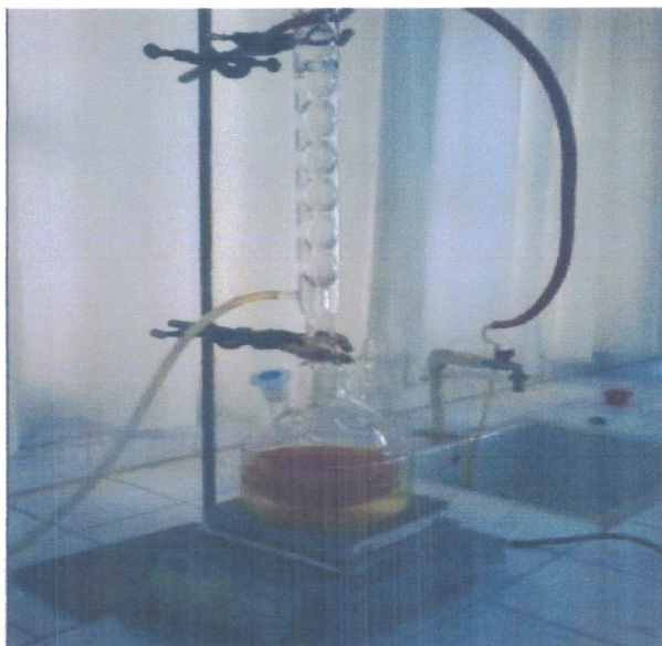
Figure 07 : le montage à reflux d'une synthèse de bases de Schiff.
