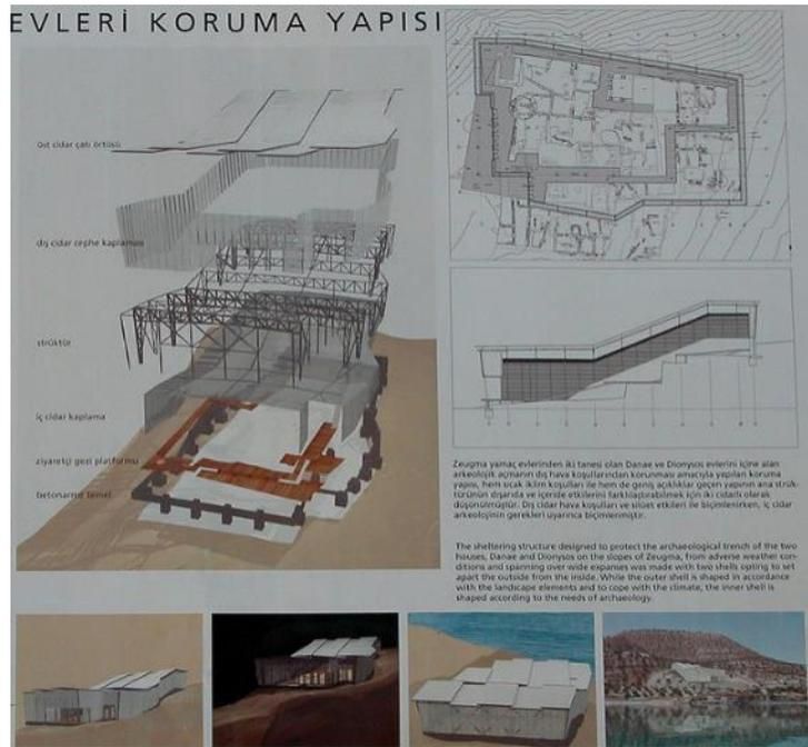
Figure 15 : plans de la structure éphémère installée sur la colline
