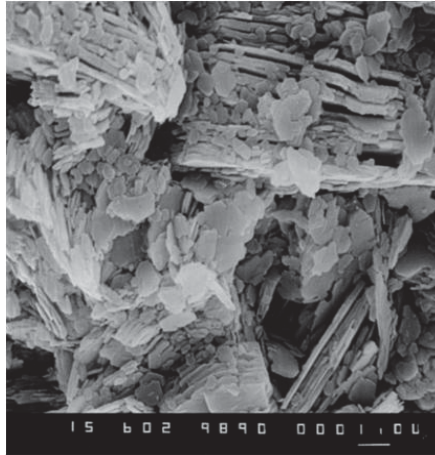
Figure 6 : SEM montrant les plaques et les piles de kaolin (1 bars = 10 \mu\text{m} ) [63].
