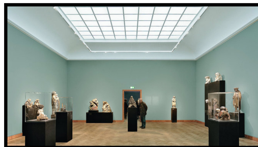
Image n°01 : exemple d'éclairage zénithal (tabatières) musée,
