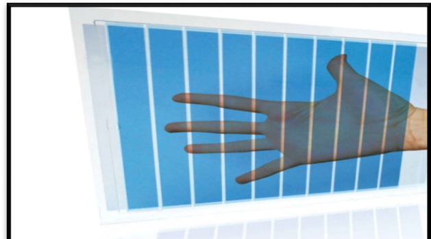
Image n°19 : une cellule photovoltaïque transparente
