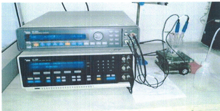
Figure 9 : Appareillage électrochimique utilisé (potentiostat).
