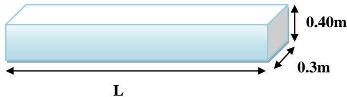
Figure II.4 Dimension de la poutre palière
