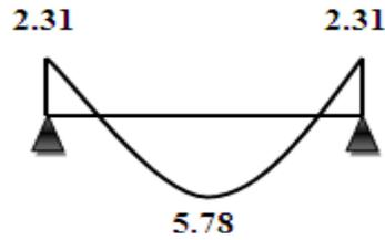
Figure III.38 Diagramme du moment à L'ELS courant
