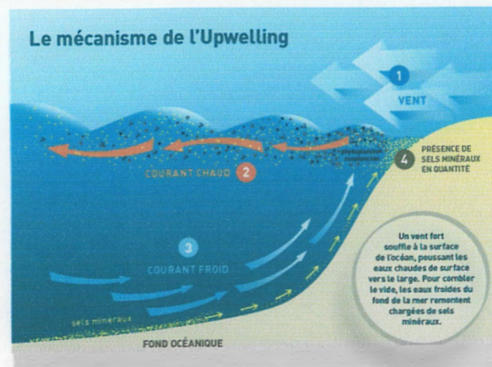
Fig.I.8-Mécanisme d'upwelling impliqué dans la genèse des gisements de phosphate sédimentaires ( http://www.plancton-du-monde.org/module-formation/phyto_02.html )
