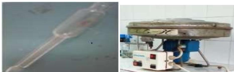
**Figure 5.** Butyromètre et centrifugeuse de séparation de matière grasse des produits analysés.
