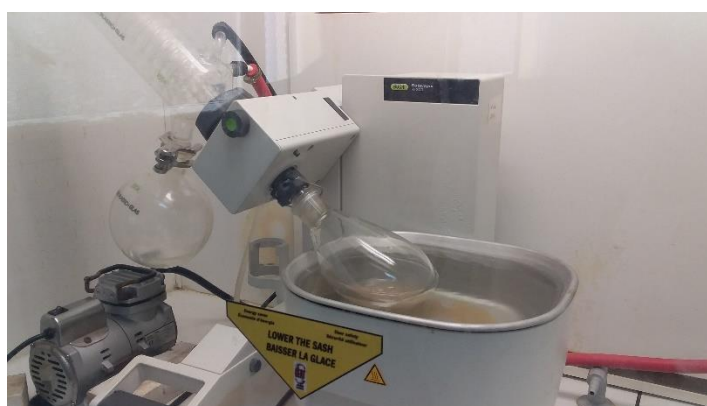
Figure 13: Evaporation du sirop par Rotavapor (R-300/ BUCHI / laboratoire de contrôle de qualité / université de Jijel).
