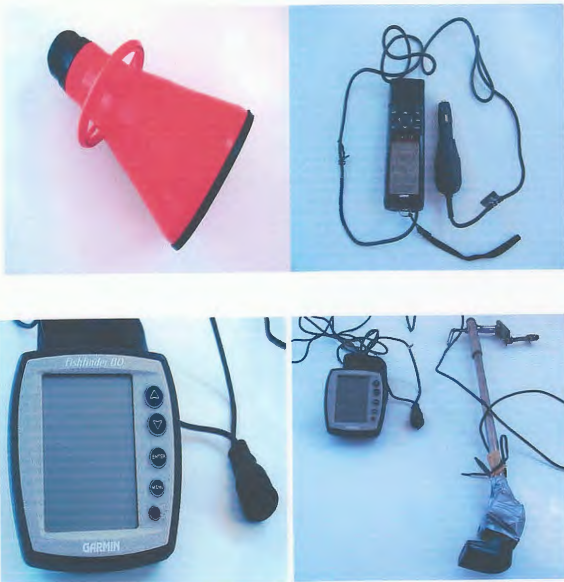
Figure 10. De gauche à droite et de haut vers le bas : seau de calfat, GPS, écran d'échosondeur et Sabot, d'échosondeur.
