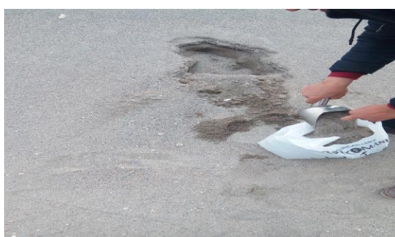
Fig 19 : Prélèvement d'échantillons du dépôt terrestre du port de Djen Djen. Avant de commencer les essais les échantillons ont été homogénéisée manuellement afin d'avoir un seul échantillon représentatif.
