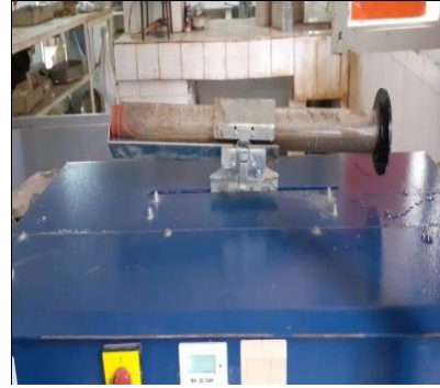
fig 27 : Machine à secouer les éprouvettes d'Es
