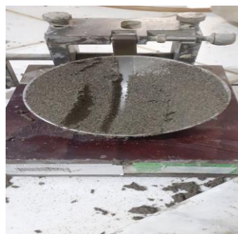
Fig 23 : Détermination de la limite de liquidité avec l'appareil de Casagrande
