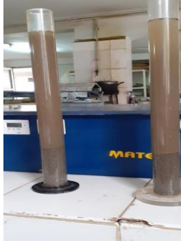
Fig 26 : Éprouvete de sable après 20min
