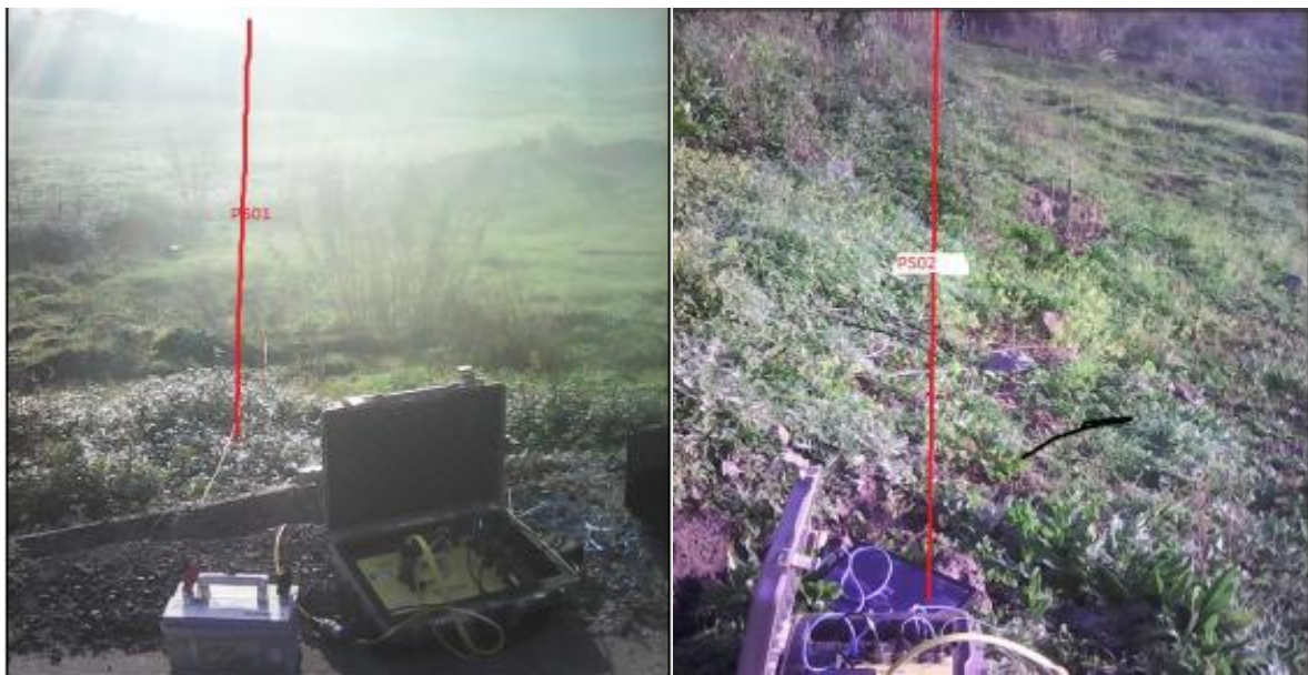
Figure IV.10: implantation d'essais de tomographie sismique.
