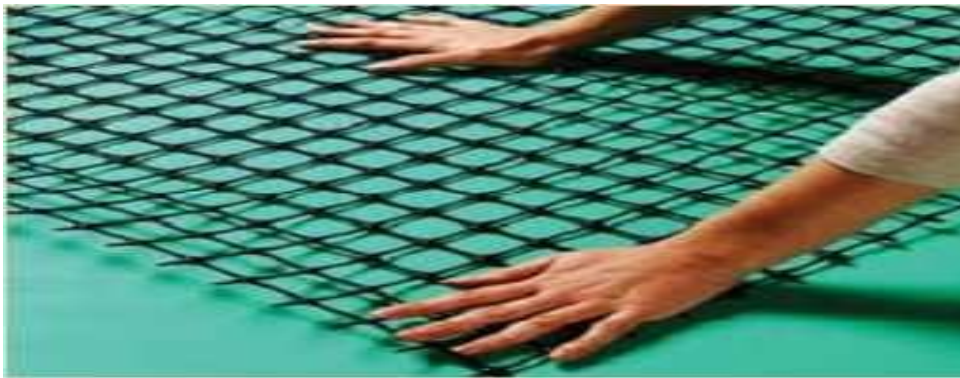
Figure III.17: Exemple de géo-grille bi-axiale [25]
