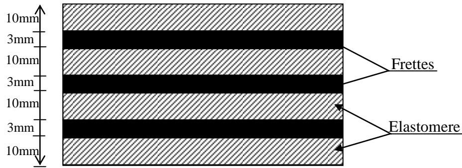
Figure.11.2 : Dimensionnement de l'appareil d'appuis.
