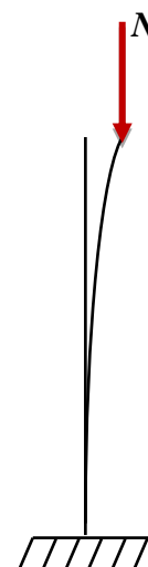
Figure.12.12 : Effet de flambement
