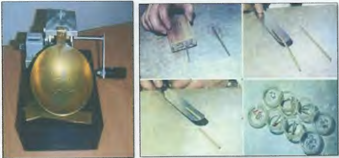
Figure.16: matériels utilisé pour déterminé la limite de liquidité et plasticité
