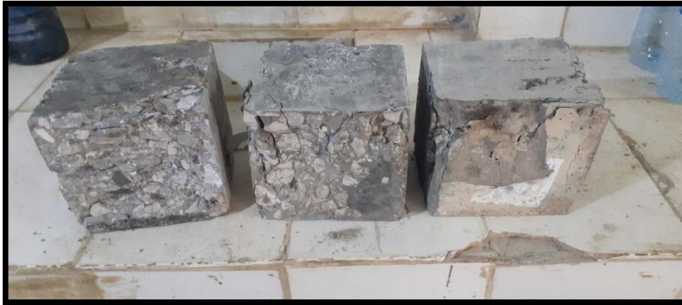
Figure III.4 : Résultat d'essai de compression.
