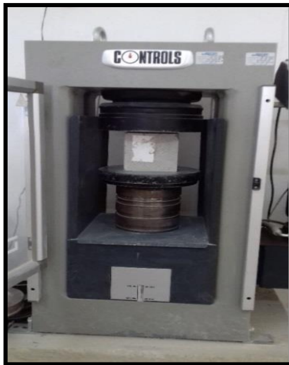
Figure III.3: Essai de résistance à la compression (Laboratoire des Travaux Publics de L'Est).
