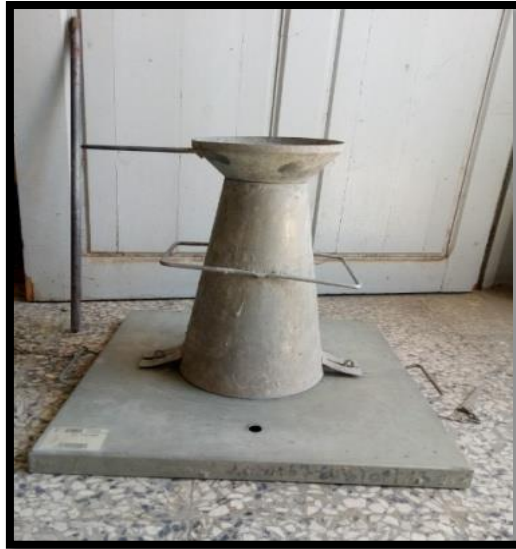
Figure III.1 : Cône d'Abrams utilisée.
