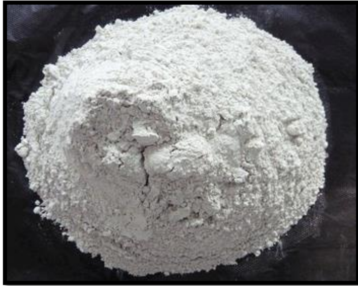
Figure I.11 : Laitier de haut fourneau granulé broyé.
