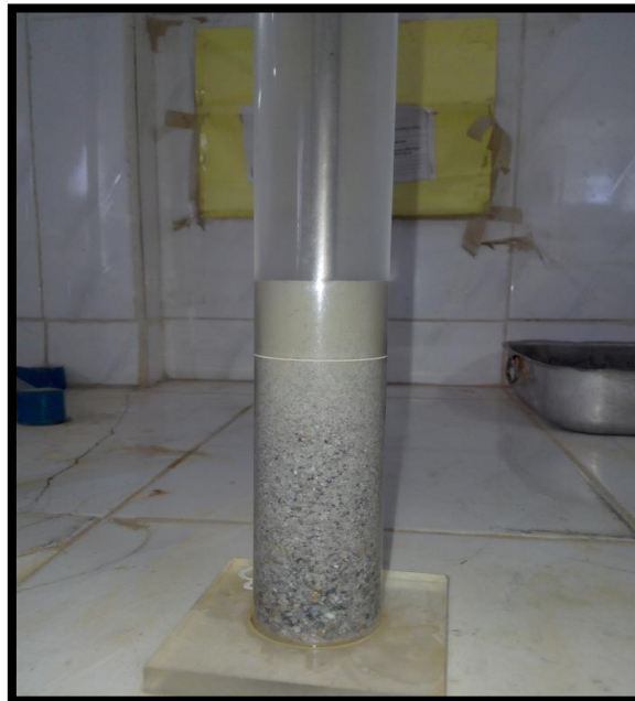
Figure II.7 : Définition de l'équivalent de sable.
