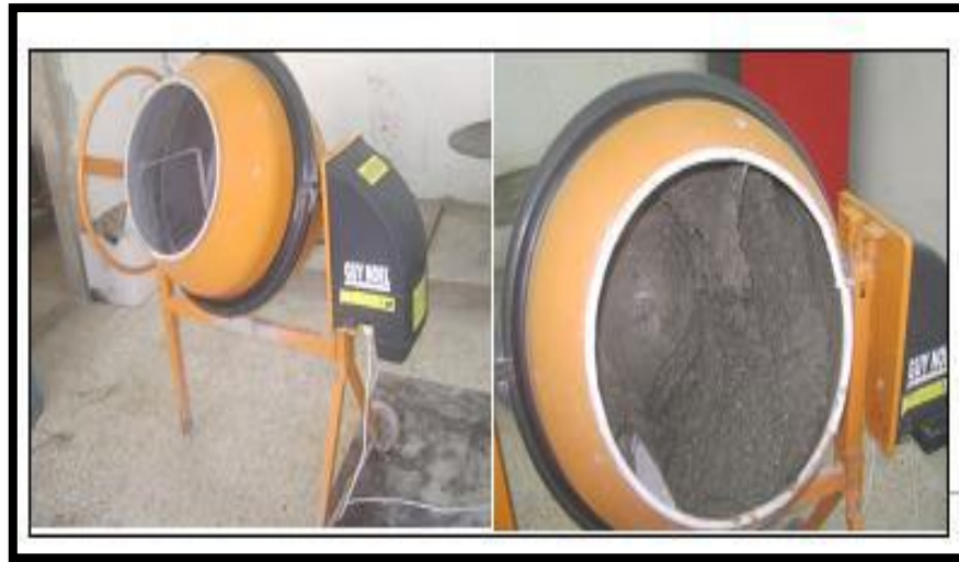
Figure I.14 : Malaxage du béton.
