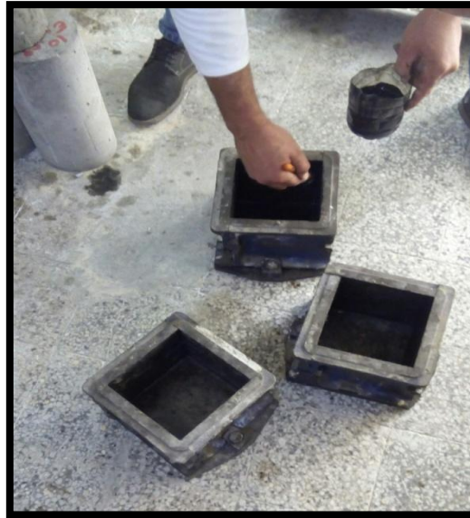
Figure II.22 : Préparation des moules avant le remplissage.
