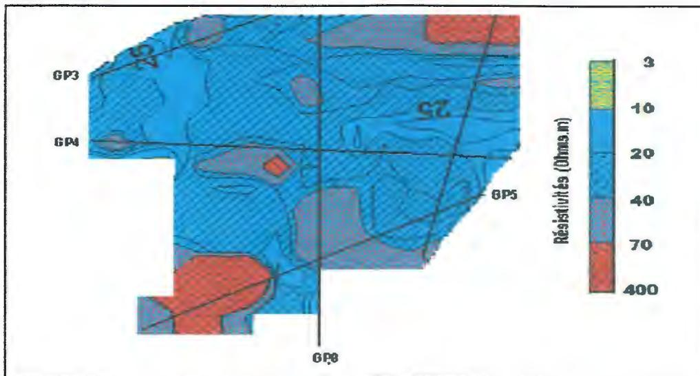
Figure III.14-b: Carte iso-résistivité à 2m de profondeur. (Chibani, 2012)
