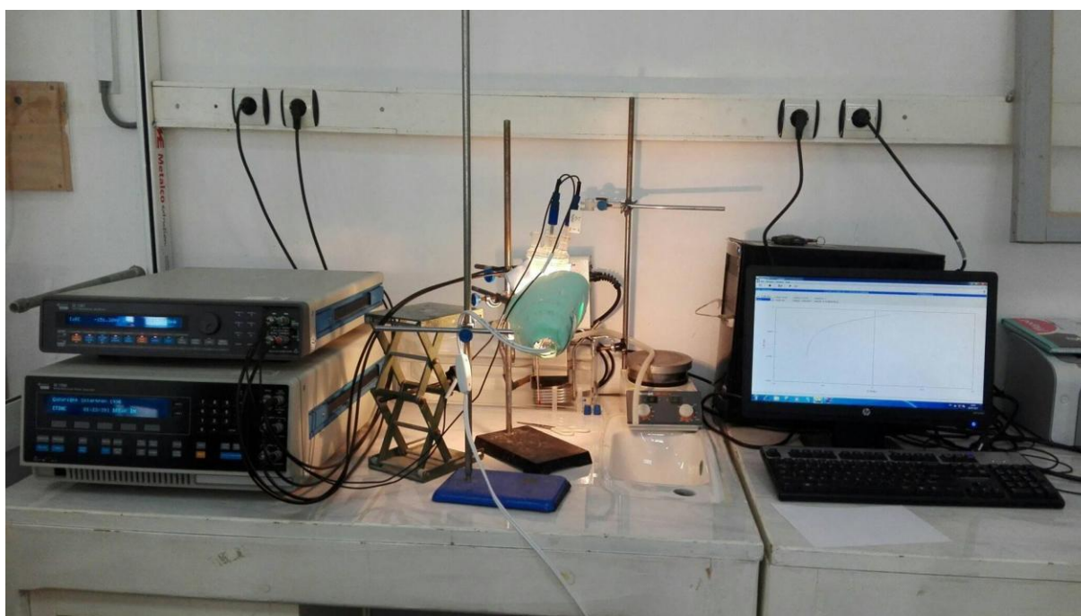
Figure IV.4: Dispositif de mesures électrochimiques.
