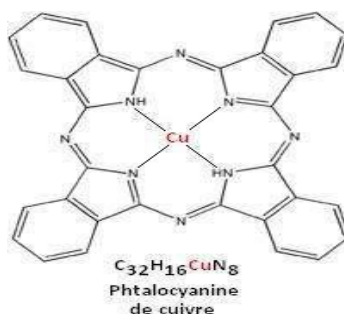
Figure I.4 : Structure de phtalocyanine de cuivre[17].
