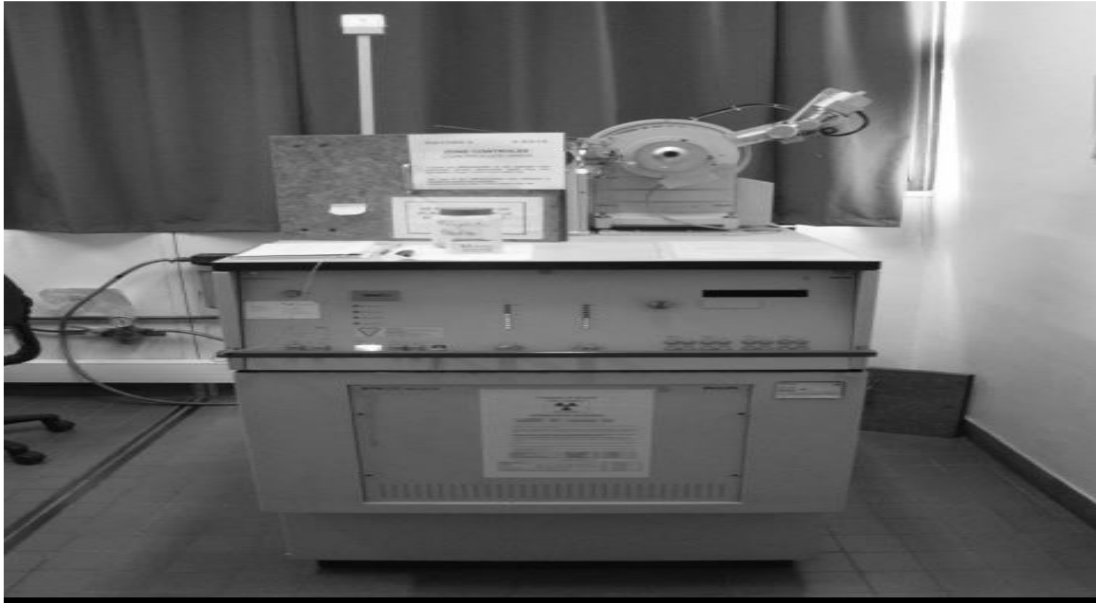
Figure II.2.- Photographie du diffractomètre Philips PW3710 utilisé pour l'enregistrement des diagrammes DRX.
