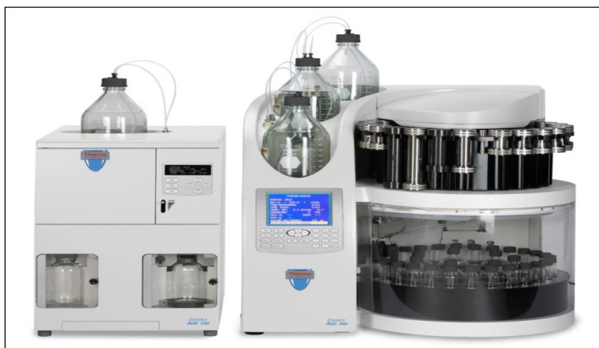
Figure 8: appareillage de l'extraction accélérée par solvant
