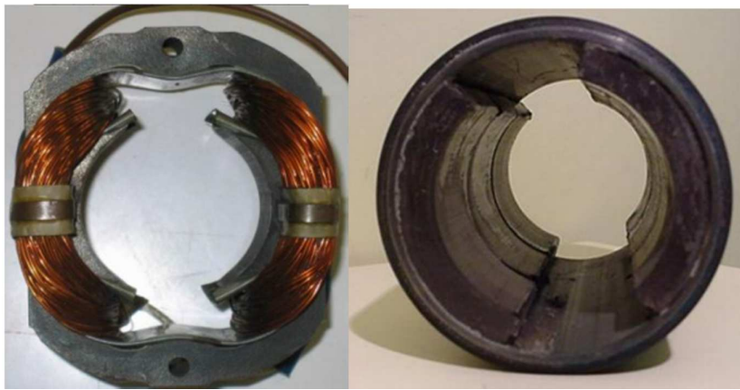
Fig. I.2 : Schéma représente un stator à aimant permanent à droite et l'autre à électroaimant à gauche de la MCC.
