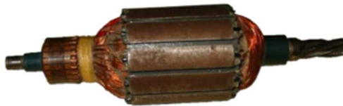
Fig. I.3 : Schéma représente le rotor de la MCC.
