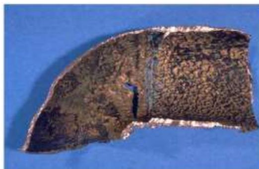
**Figure II.9 :** Corrosion par érosion dans une zone turbulente.
