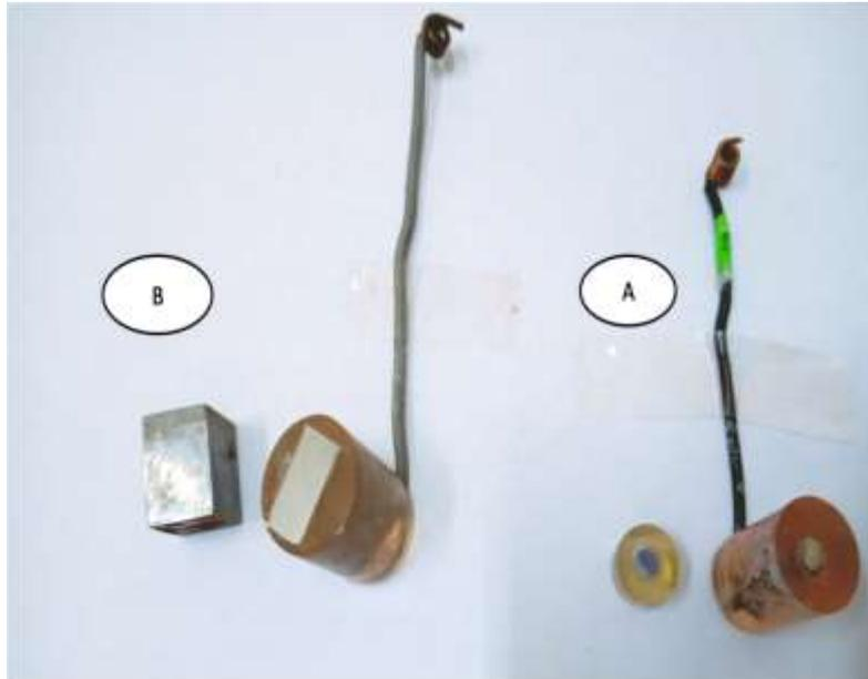
**Figure III.3 :** Echantillons pour les essais de caractérisation électrochimique.
