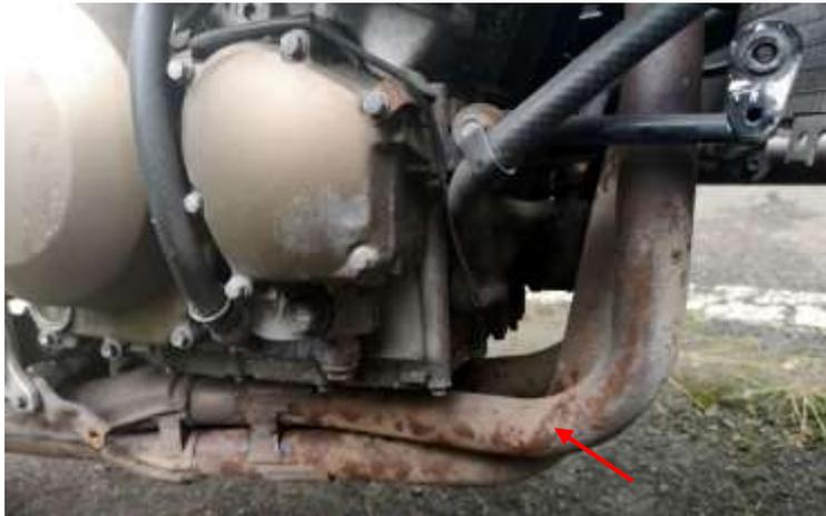
Figure II.2: La corrosion sèche
