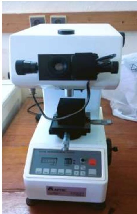
**Figure III.6 :** Microduromètre AFFRI Model DM2D, laboratoire de physique de l'université de Jijel.
