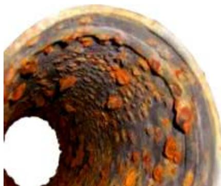
Figure II.3 : La corrosion bactérienne.
