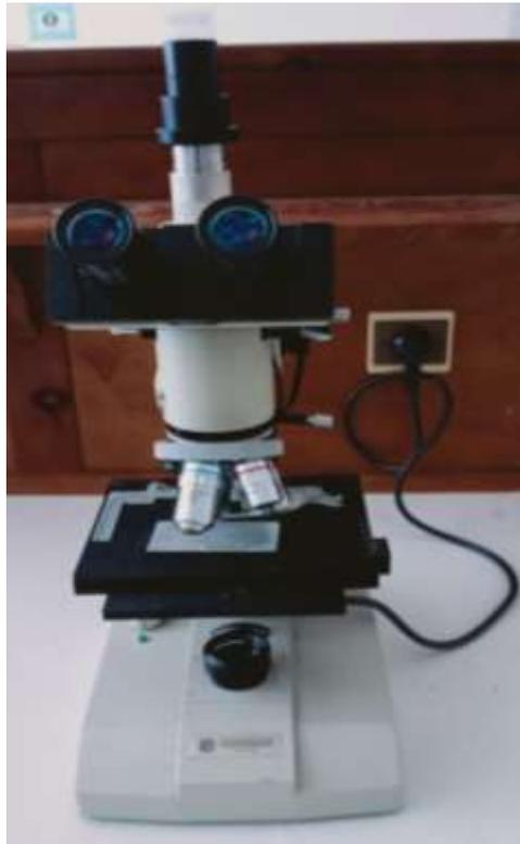
**Figure III.4 :** Microscope optique métallographique.
