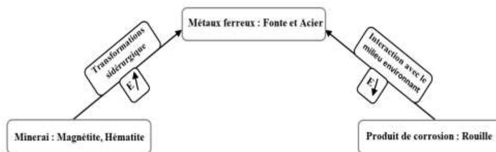
**Figure II.1** : Schéma traduisant la cause de la corrosion atmosphérique du fer.
