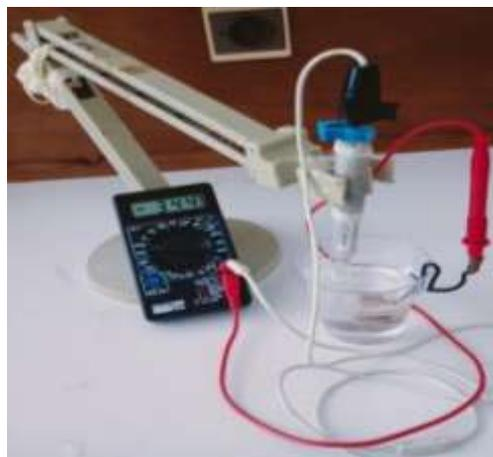
**Figure III.8 :** Montage pour la mesure de potentiel.
