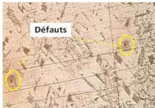
**Figure IV.3 :** Défauts de surface sur l'acier brut de coulé avant laminage (billette)
