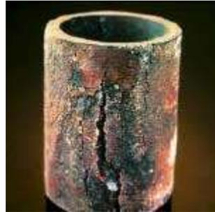
**Figure II.13:** Fragilisation par l'hydrogène.
