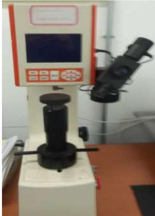
**Figure III.5 :** Duromètre universel du complexe AQS.
