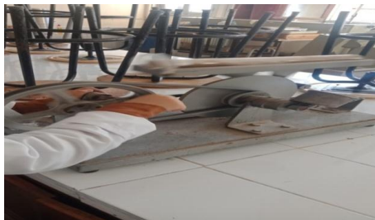
Figure III.6 : Agitation de l'éprouvette en position horizontale (90 cycles).
