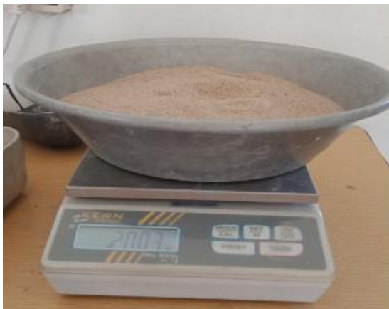
Figure III.2 : (a) : Pesage de sable, (b) : tamisage de sable dans la tamiseuse électrique.
