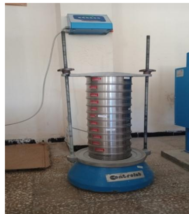
Figure III.2 : (a) : Pesage de sable, (b) : tamisage de sable dans la tamiseuse électrique.
