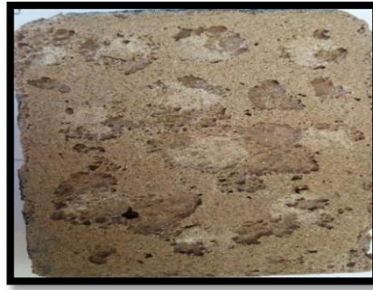
Figure II.8 : Zone des dix martèlements sur la surface de l'échantillon S-PS.
