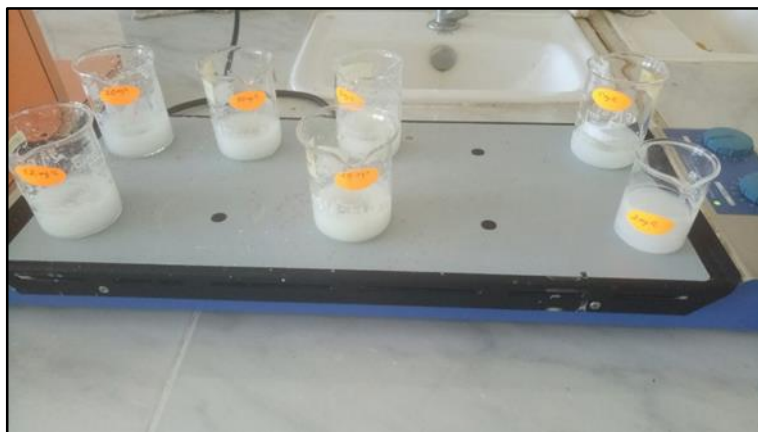
Figure (II.6) : Dispositif expérimental d'un essai d'adsorption du naphthalène sur ZnAl_2O_4/CeO_2
