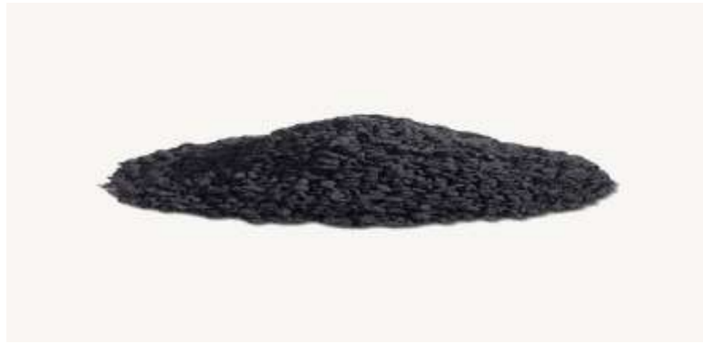
Figure I.3 : Charbon actif granulé (Lu Jinyan, 2005).
