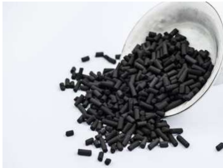
Figure I.4 : charbon actif extrudé (Lu Jinyan, 2005).
