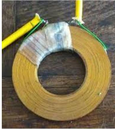
**Figure. III.7** : Bobine réalisée à l'aide d'un ruban supraconducteur
