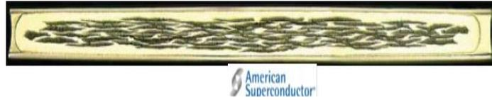
**Figure II.1:** Forme de matériau SHTC en BSCCO (*Bi-2223*)
