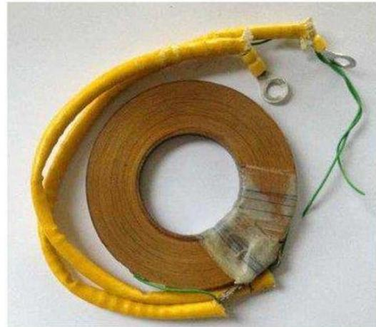
**Figure. I.12 :** Échantillon du ruban et image d'une bobine supraconductrice [13].
