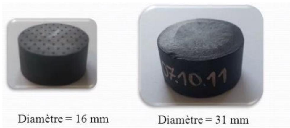
**Figure. I.13 :** Supraconducteur sous forme de pastille.
