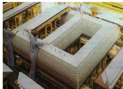
**Figure (I.18) :** circuit magnétique triphasé
