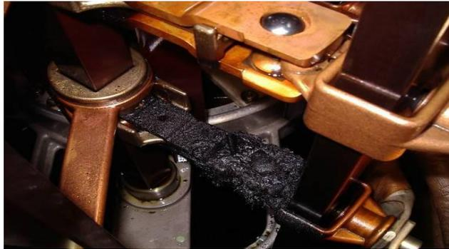
**Figure(III.4) :** Point chaud du sélecteur du régulateur en charge
