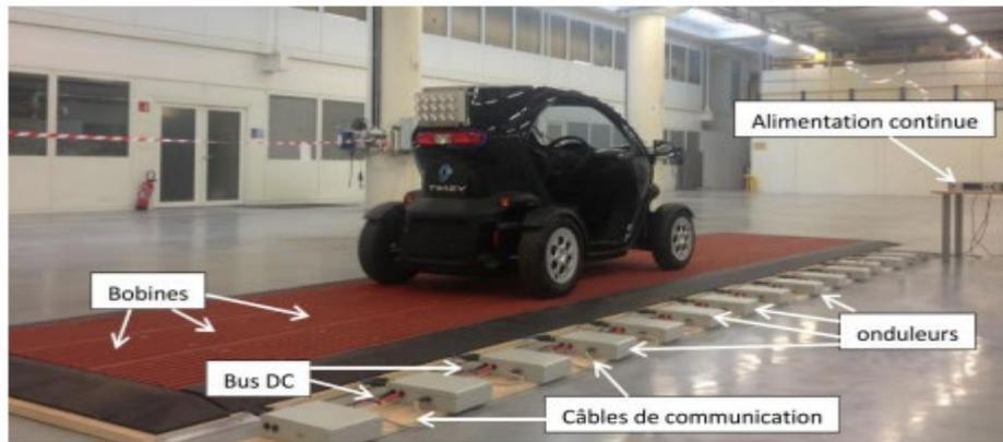
Fig.I.9 : Système DWPT développé par Renault-Supelec, source [16]
