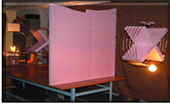
Fig.I.5 : Bobines utilisées par le MIT pour tester la résonance magnétique.
