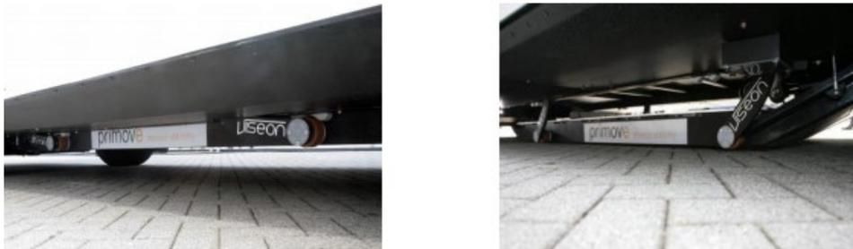
Fig.I.4 : Secondaire du système Primove développé par Bombardier, (a) secondaire pendant le déplacement, (b) secondaire abaissé lors de la recharge
