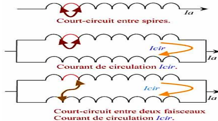
Fig. I. 17. Différents court-circuit entre spires
