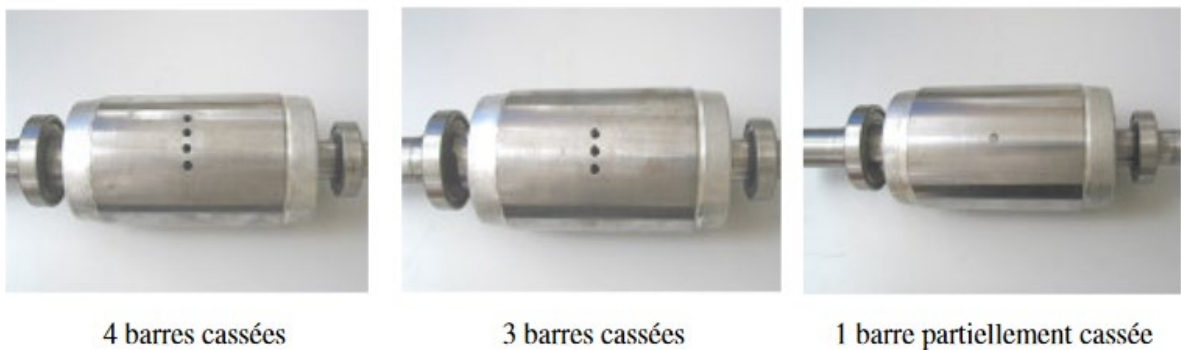
Fig. I. 20. Défaut de rupture de barres
