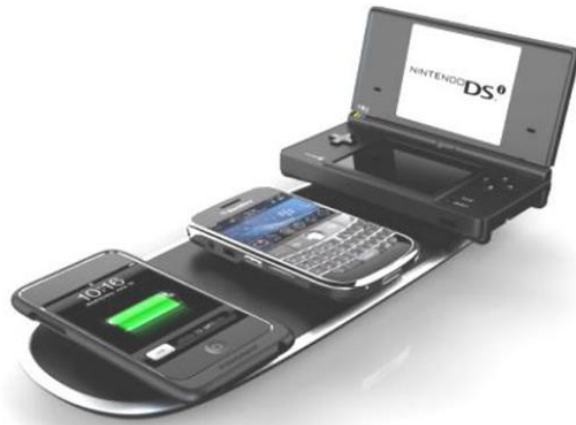
Figure I.1 : Recharge sans contact pour des appareils mobiles
