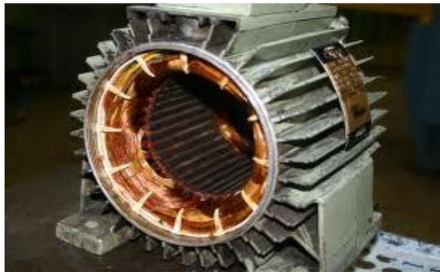
*Figure (1-7) Stator d'une machine asynchrone*
