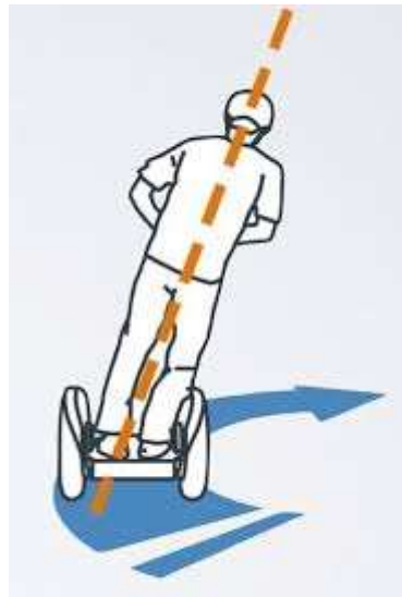
Figure (I-6): Principe de fonctionnement du Segway - pour tourner
