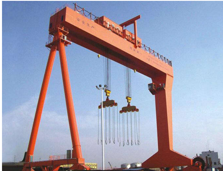
Figure 1.2 grue portique d'une capacité de levage de 600 tonnes.
