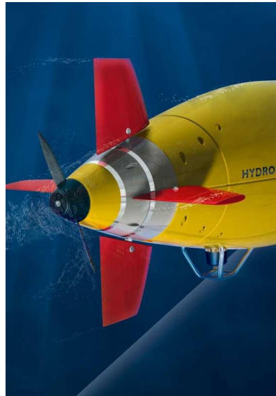
Figure 1.13 : Surfaces mobiles de l'AUV REMUS 6000.
