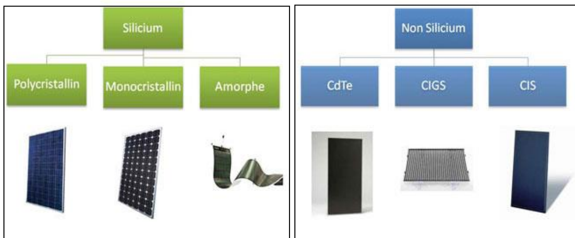
Figure II.2 : Cellules à base de silicium. Figure II.3 : Cellules à base de couche-mince.
