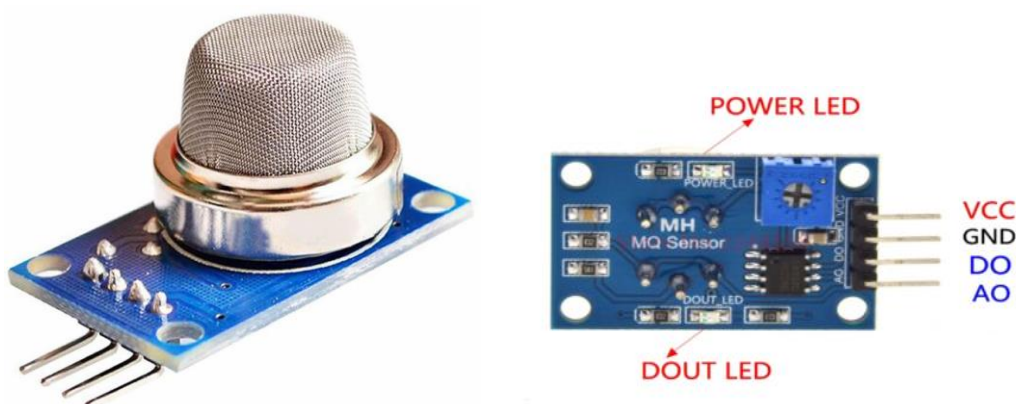
Figure 2.7: Capteur de gaz MQ2 et son schéma de brochage.
