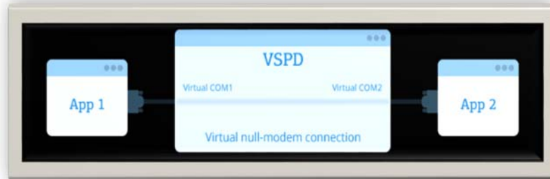
Figure II.10: Figure montre le rôle du VSPD.
