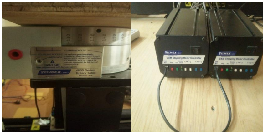
Figure3.2 : Tables de positionnement de marque Velmex, utilisée pour régler la hauteur des antennes avec haute précision dans les axes xyz.
