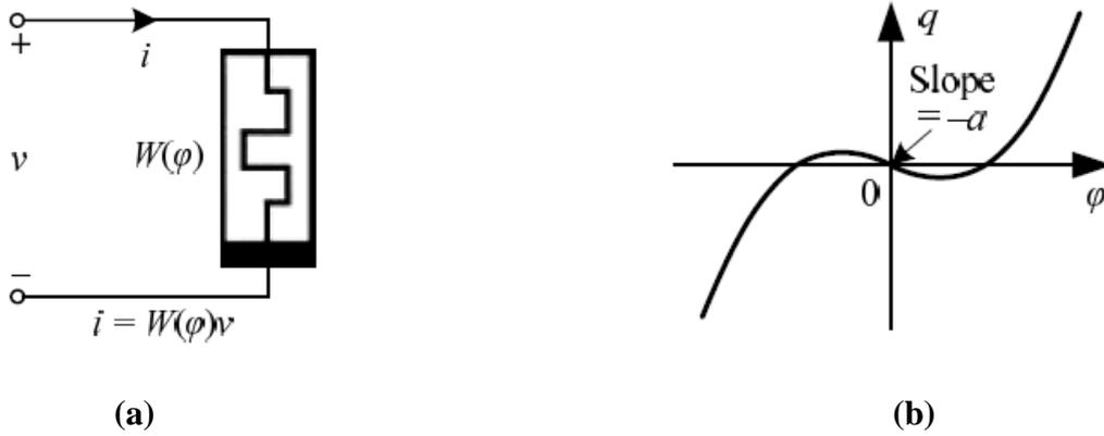
**Figure (3.1) : Memristor actif à flux contrôlé.**
