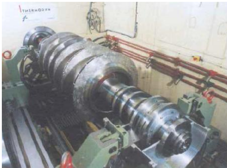
Figure II.9 Chambre d'équilibrage sous vide. [1]
