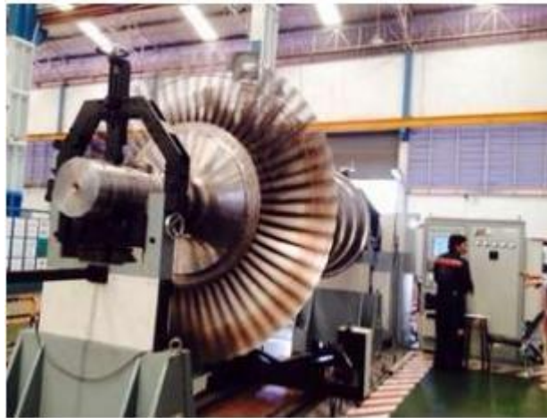
Figure II.8 Machine d'équilibrage horizontale. [1]
