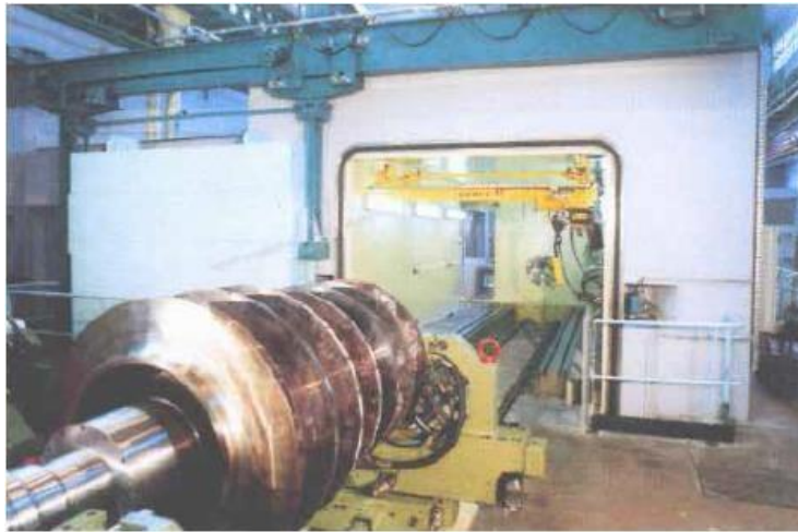
Figure II.9 Chambre d'équilibrage sous vide. [1]
