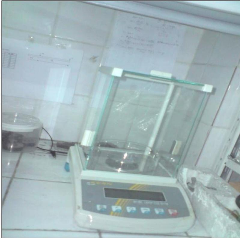
**Figure II.4.** Microbalance de précision  $10^{-5}$  g
