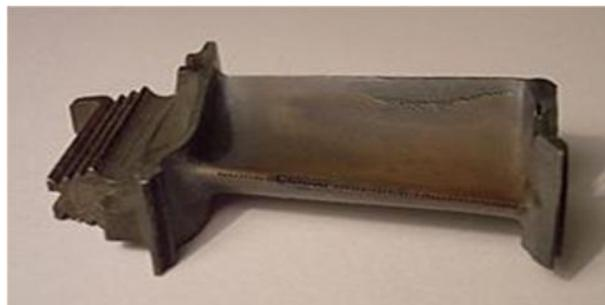
**Figure I.10.** Usure d'Erosion [19].
