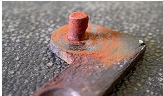
**Figure I.9.** Usure de corrosion [19].
