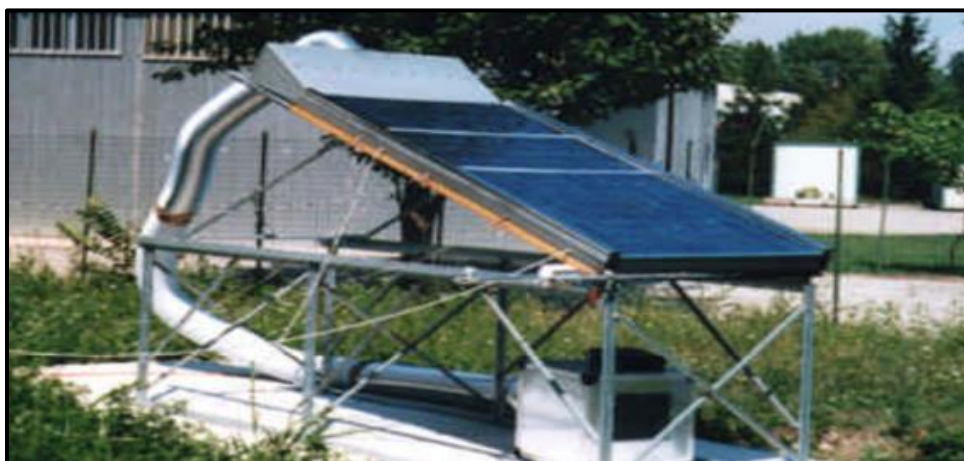
Figure 10.b : Les capteurs solaires hybride PV/T à air [12].
