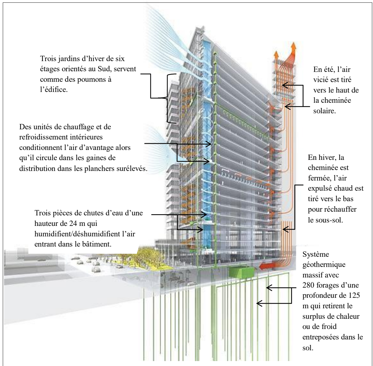
Figure III-19 : Le système de ventilation, de refroidissement passif et de chauffage du nouveau siège social de Manitoba Hydro.
