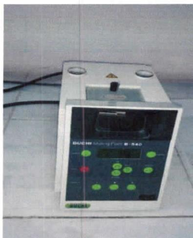
**Fig III.7.** Fusiomètre utilisé pour la mesure de la température de fusion de la théobromine extraite.
