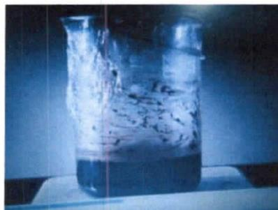
Fig III.3. Agitation après ajout du DCM avec un agitateur magnétique pendant trois heures.
