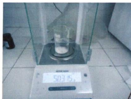
Fig III.1. Pesées du cacao et d'hydroxyde de magnésium.
