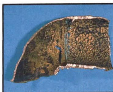
Corrosion par érosion
