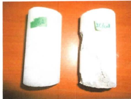
**Figure 25 : Specimens avant et après écrasement**
