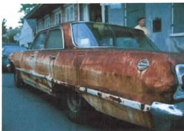
**Figure 5 : Corrosion généralisée d'une porte et d'un véhicule.**
