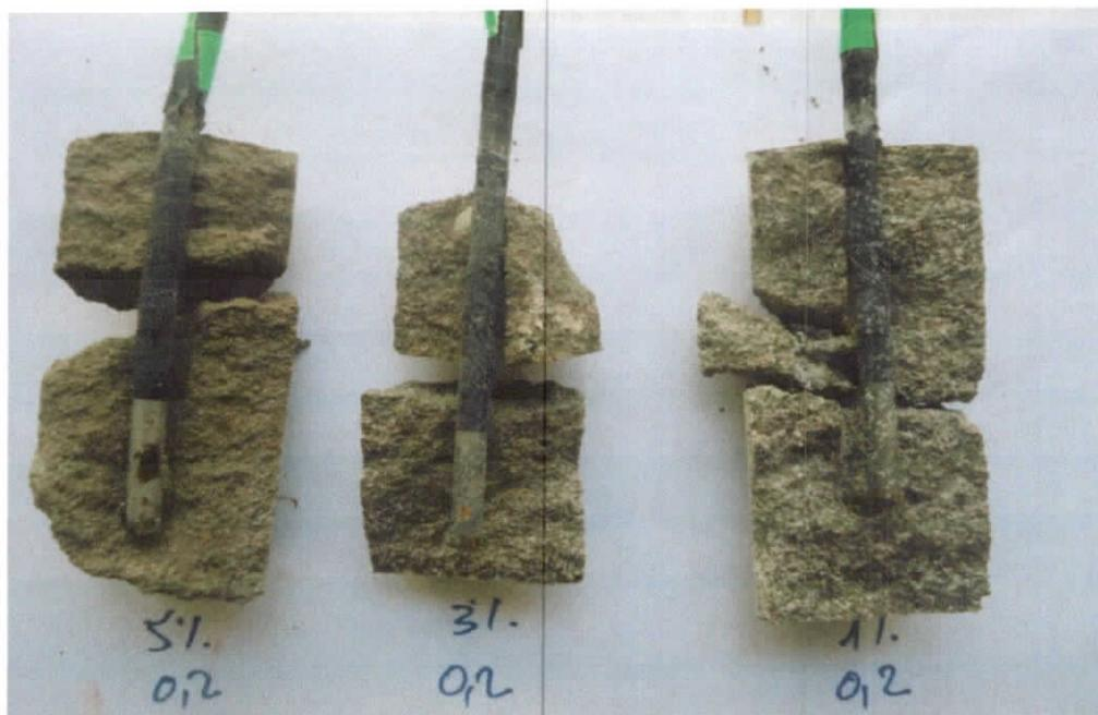
**Figure 46 : Macrographies traduisant l'état de l'acier après immersion de 8 jours dans la solution 3%NaCl : Granulométrie = 0.02 mm**
