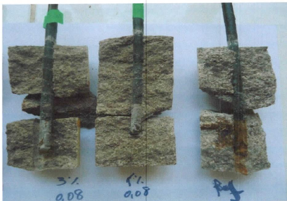
Figure 47: Macrographies traduisant l'état de l'acier après essai de corrosion accélérée : Granulométrie = 0.08 mm
