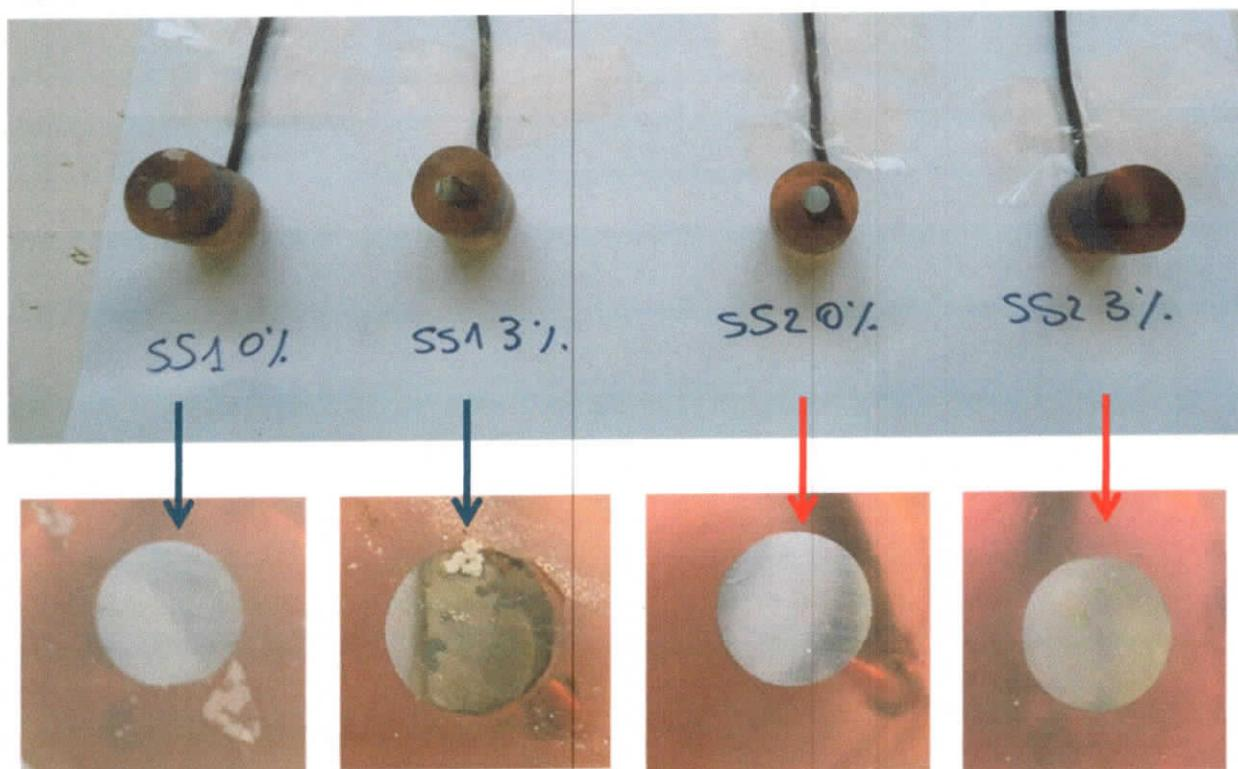
**Figure 36 : Macrographies des échantillons en acier après immersion de 7 jours dans les différentes solutions simulées, sans et avec chlorures**
