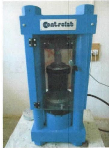
**Figure 24 : Presse hydraulique modèle CONTROLAB**
