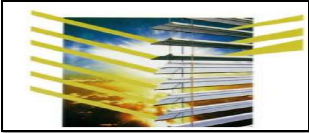
Figure 59 : store permettant de régler la direction de la lumière.
